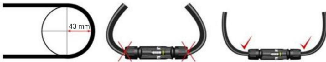
图 6 线缆的最小弯曲半径
