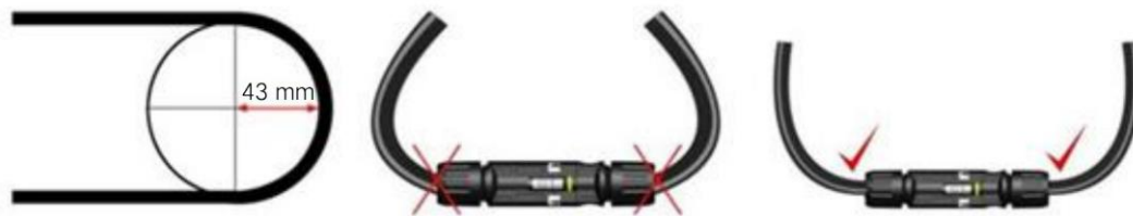
图 6 线缆的最小弯曲半径
