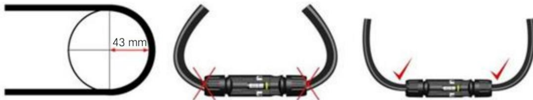
图 8 电缆的最小弯曲半径
